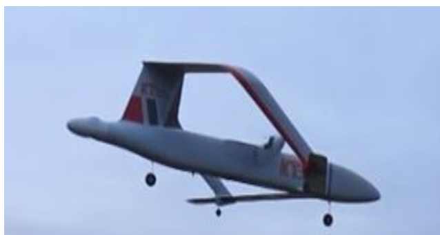
Изображение 1. Дрон «Frigate» разработан «Kronstadt Technology» способен нести большие грузы 1700 кг на расстояниях до 5000 км со скоростью до 700 км/ч.
